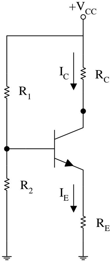
$$V_{CC} - I_C R_C - V_{CE} - I_E R_E = 0$$
